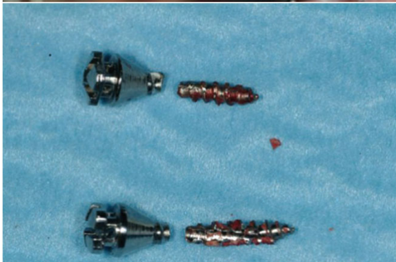
矯正釘在移除時發生斷裂
