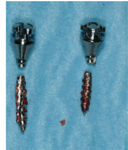
矯正釘在移除時發生斷裂
