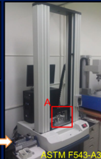
ASTM F543-A1 (旋斷強度測試)
