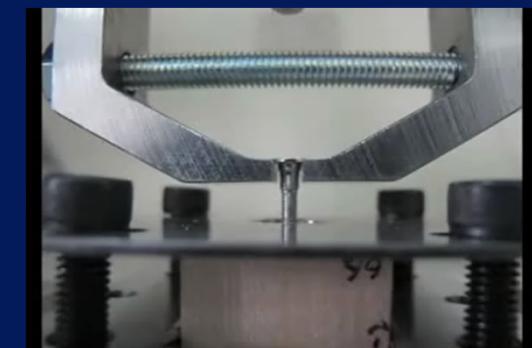
ASTM F543-A3 (拔出強度測試)
