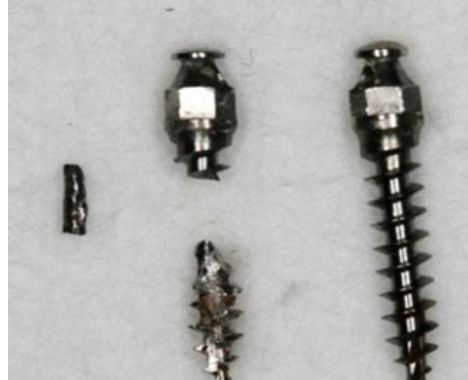
矯正釘在移除時發生斷裂
