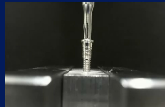
ASTM F543-A1 (旋斷強度測試)
