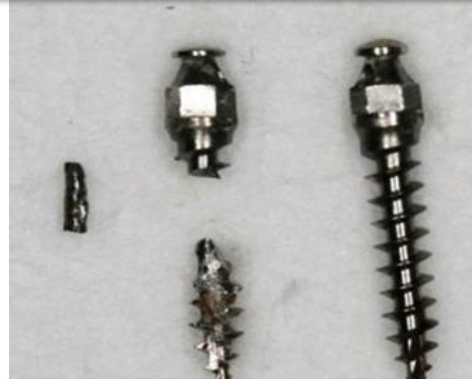
矯正釘在移除時發生斷裂
