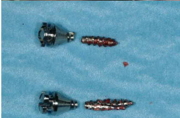
矯正釘在移除時發生斷裂
