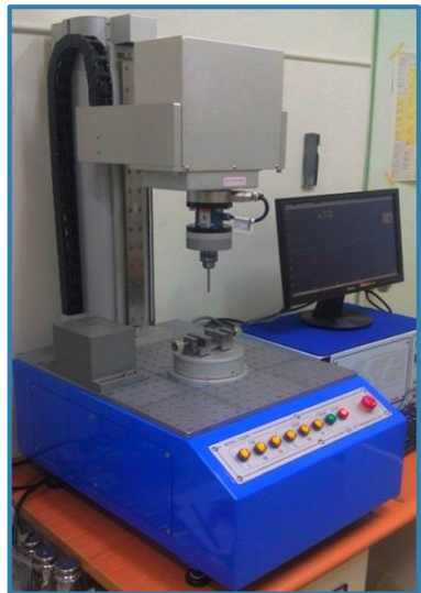
扭轉材料靜態試驗機 (SE MODEL 2205NS, SE)
