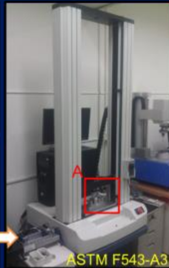
ASTM F543-A1 (旋斷強度測試)
