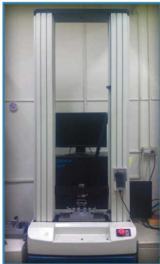
軸向材料靜態試驗機 (HT-2402EC, Hung-Ta)
