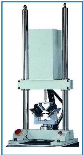
機電雙軸材料動態試驗機 (HT-1236FR100, Hung-Ta)
