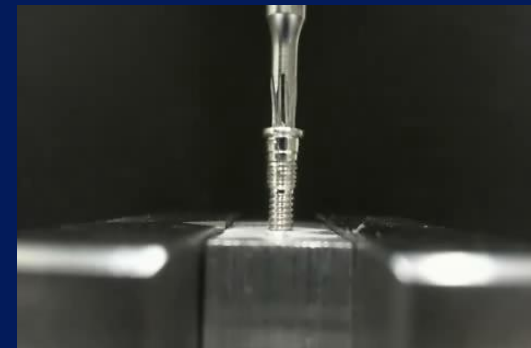
ASTM F543-A1 (旋斷強度測試)
