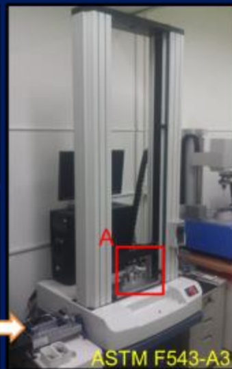
ASTM F543-A1 (旋斷強度測試)
