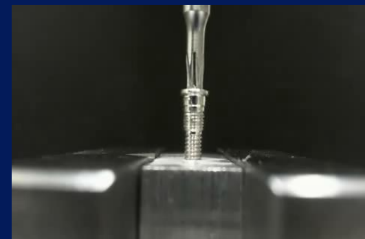
ASTM F543-A1 (旋斷強度測試)
