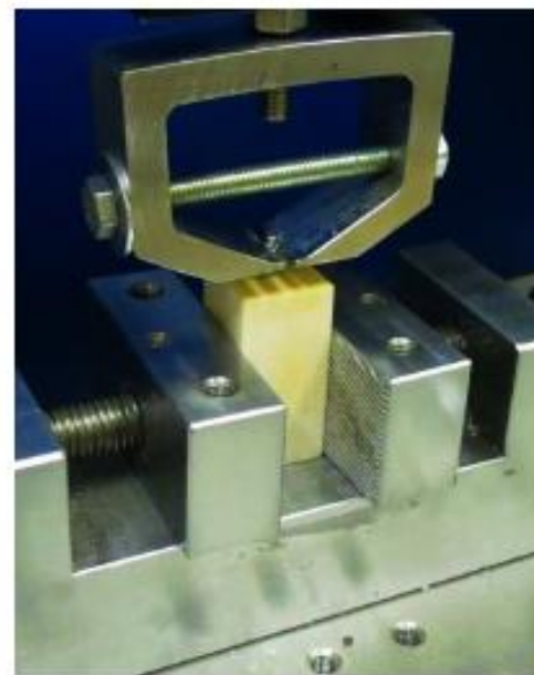
軸向拉出測試
