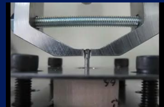
ASTM F543-A3 (拔出強度測試)
