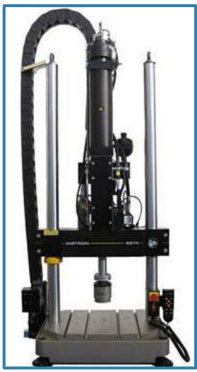
油壓雙軸材料動態試驗機 (Instron 8874, Instron)
