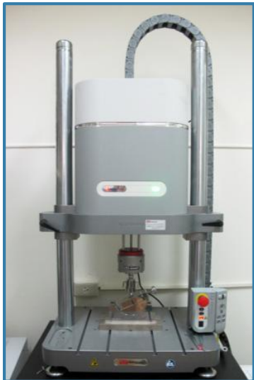
機電軸向材料動態試驗機 (Instron E3000, Instron)
