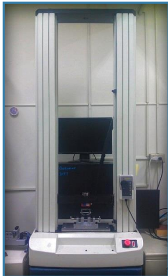
軸向材料靜態試驗機 (HT-2402EC, Hung-Ta)
