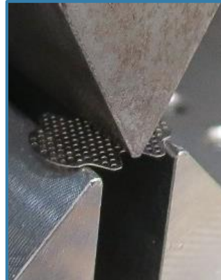
鈦網靜態 三點彎曲測試
